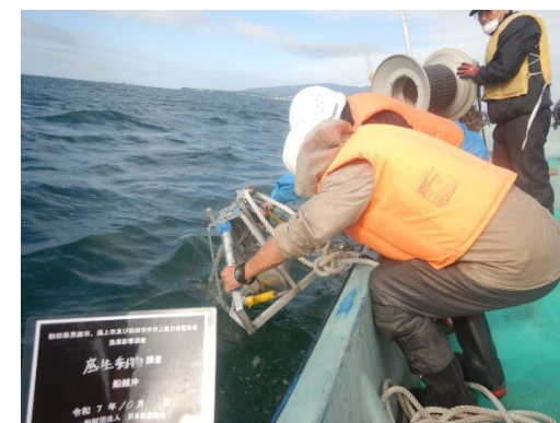
▲調査写真（スミス・マッキンタイヤ型採泥器）
